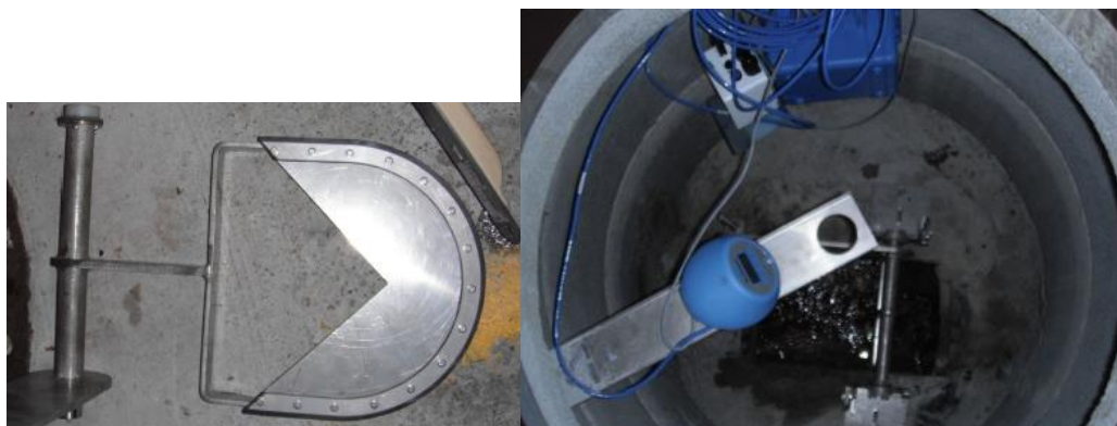
Figur 16: Vannføringsmålinger i rør med v-overløp og ekkolodd for registrering av nivå. (Figur: Norconsult).
