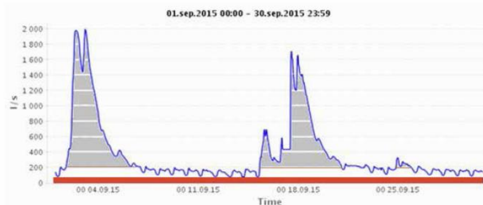
Figur 5: Fremmedvann, ulike komponenter: Grunnvannsinnelekk (rødt), nedbørvhengig innelekk (grått), spillvannsvannføring (øvrige areal under blå graf)
