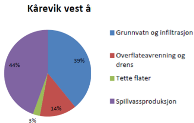
Figur 13: Analyse av vannføringsmålinger – estimat av avløpsvannets sammensetning og fremmedvann.
