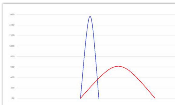
Figur 6: Avrenningens form – blå fra areal dominert av tette flater og overvannsavrenning, rød fra areal med mer permeable flater og større andel avrenning via grunnen. (Figur: Oddvar Lindholm)
