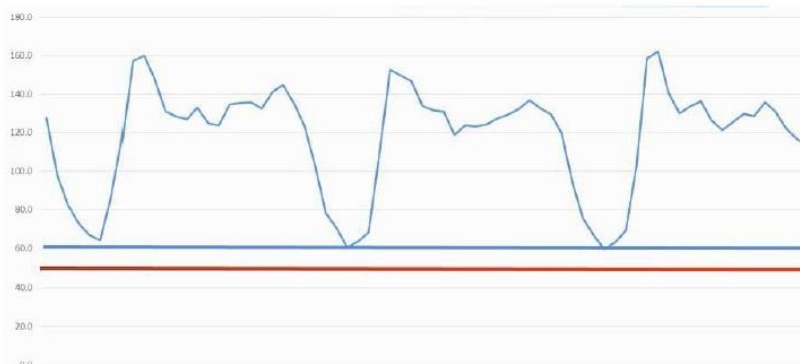
Figur 4: Eksempel på måledata over tre døgn. Blå vannrett linje: Nattforbruk. Rød linje: Fremmedvannsmengde, grunnvannsinnlekking (målt nattforbruk minus forventet nattforbruk fra spillvannsproduksjon).
