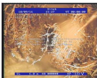
Figur 3: Rørinspeksjon som viser utette rør – grunnet utett rørskjøt, rotinntrenging og kollaps. (Foto: Stord kommune/Vitec)
