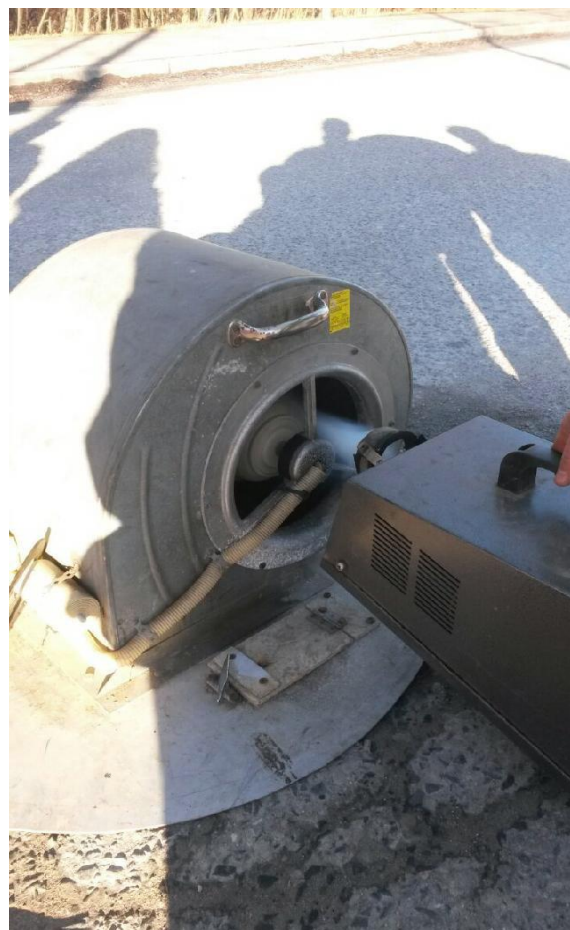
Figur 3: Røykmaskin som brukes for røyktesting
