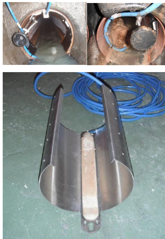
Figur 9: Måleutstyr for mengdemåling, med ultralyd hastighetsmåler og trykksensor med festering til montering i rør. Foto: Norconsult.
