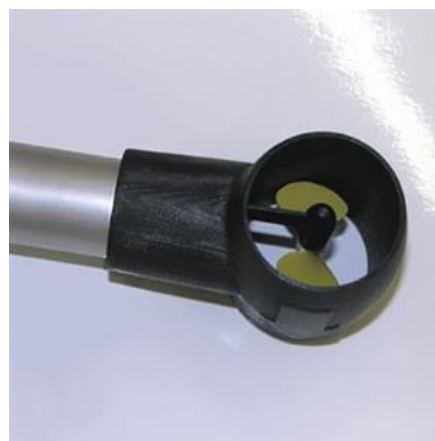
Figur 8 Håndholdt hastighetsmåler for øyeblikksmålinger
