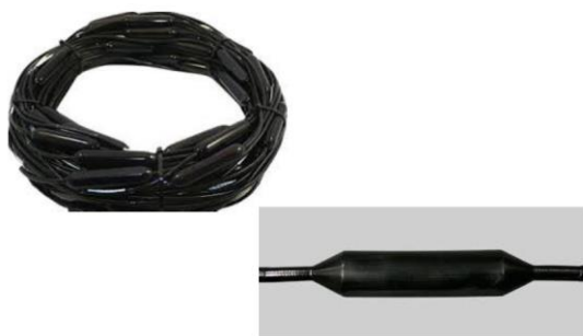
Figur 15: Temperaturstreng til registrering av temperatur i spillvannsledninger.
