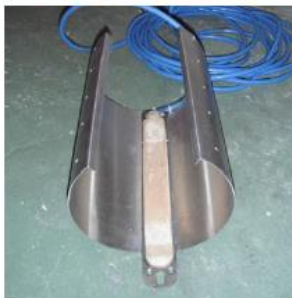
Figur 9: Måleutstyr for mengdemåling, med ultralyd hastighetsmåler og trykksensor med festering til monterings i rør. Foto: Norconsult.
