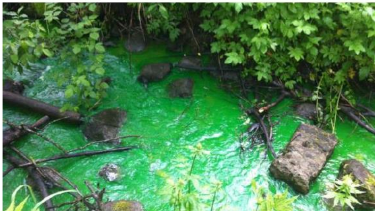
Figur 5: Sørabekken i Trondheim farget grønn med sporstoff i forbindelse med feilkoblingssøk. Foto: Adresseavisen
