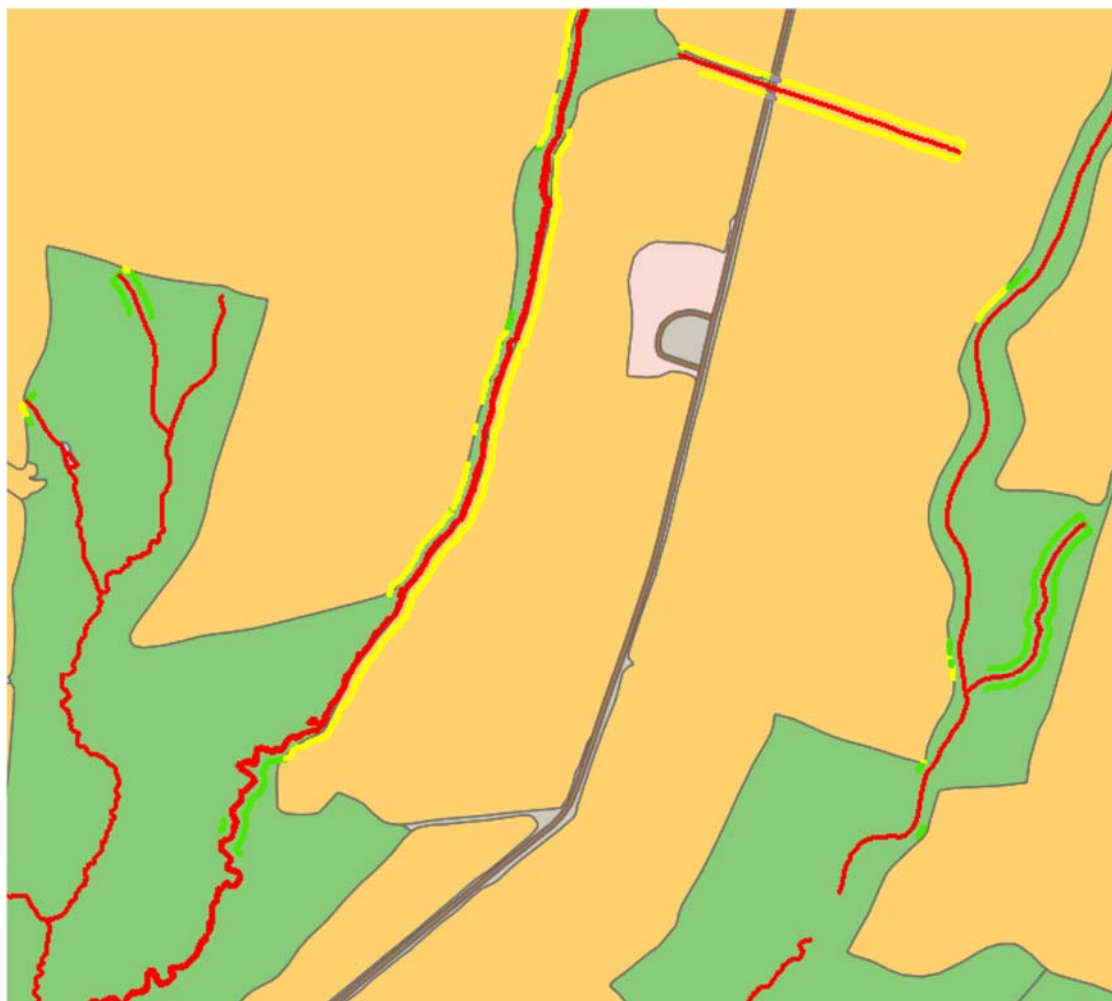
Figur 1. Bekkestrenger (rød) og beregnede buffersoner (gul, grønn) der fargen angir markslagskode. Gule strenger ligger på jordbruksareal. Grønne strenger ligger i skog som vokser på jordsmonnlagt areal. Disse er regnet med i tabell 1 men ikke i tabell 2.
